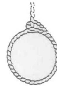
VAL: L'AJUST DEL TRAU TALLA EL CABLE EN MOVIMENT
