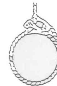
VAL: L'AJUST DEL TRAU TALLA EL CABLE EN MOVIMENT
