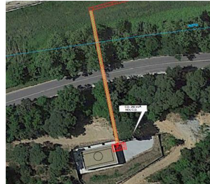
Il·lustració 1: Creuament amb la perforació dirigida de la carreta BV5001 i del Torrent.
