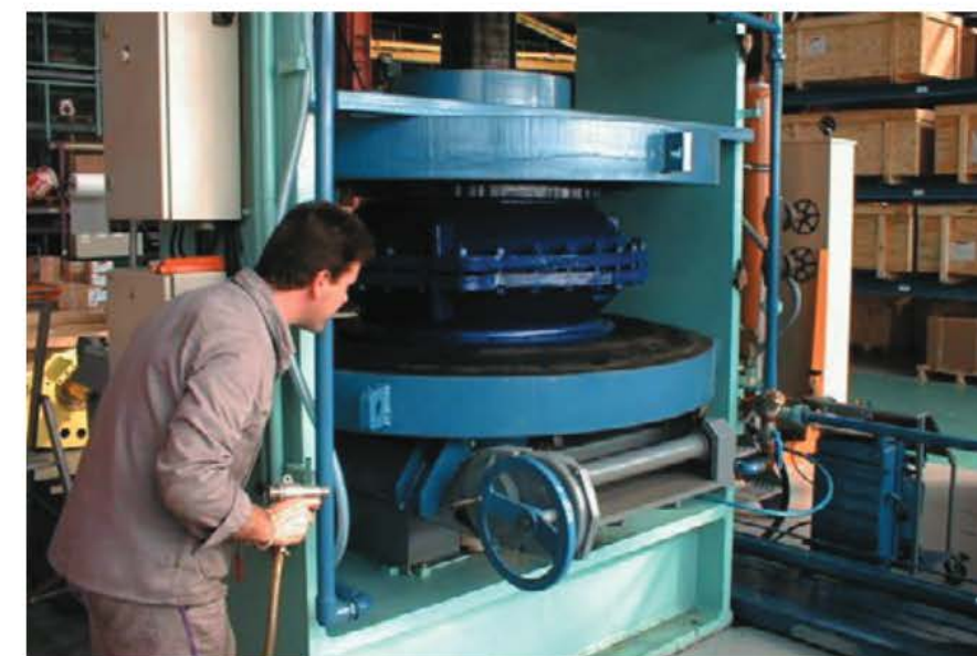
Ejemplo de una prueba sobre DN700 (28") realizada para cada una de las válvulas de nuestra producción
