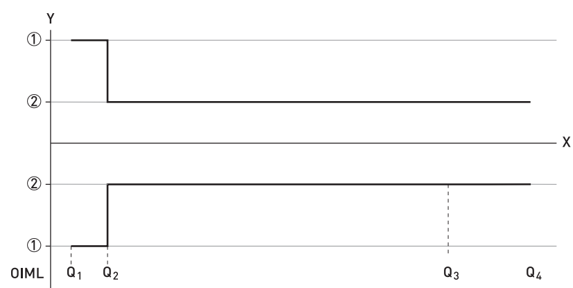
Figura 2-1: Velocidades de caudal ISO añadidas a la figura para una comparación con OIML
