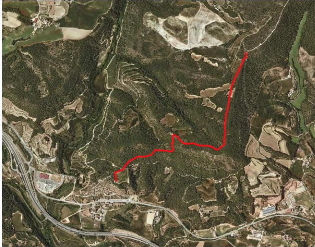
Figura 4. Planta general de la conducció de derivació
